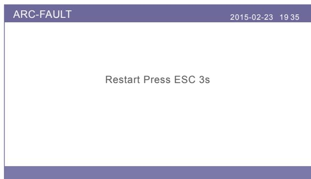
L'installatore deve ispezionare a fondo il circuito DC per assicurarsi che tutti i cavi siano correttamente fissati.
