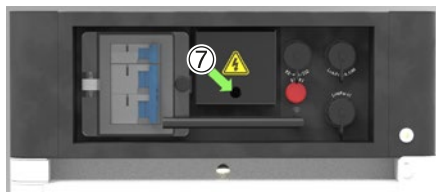
Fig. 4.1 - Coperchio di protezione (7) dei terminali di alimentazione
