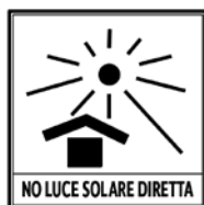
Fig. 3.1 - Non esporre alla luce solare diretta, campo di temperatura 0° - 50°C, installare su un terreno piano e uniforme.
