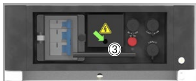
Fig. 3.14 - Coperchio di protezione (3) dei terminali di alimentazione
