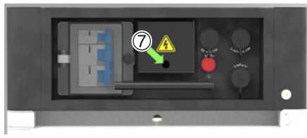
Fig. 4.6 - Coperchio di protezione (7) dei terminali di alimentazione
