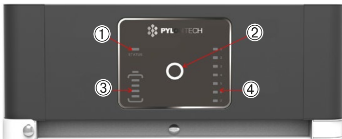
Fig. 3.13 - Display del modulo di controllo FC0048-100S 1) indicatore stato sistema, 2) pulsante led, 3) indicatore livello di carica batteria (una tacca indica il 25% di carica), 4) indicatore di stato del modulo batteria
