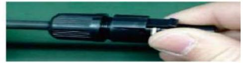
Führen Sie das abisolierte Kabel in den Steckeranschluss ein und crimpen Sie den Steckeranschluss wie unten gezeigt.
